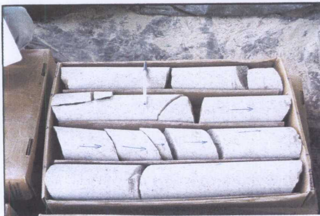
CAJA 29 . Aspecto general. Sistema de fisuras paralelas.
