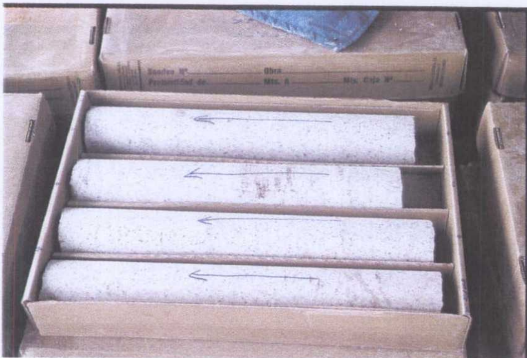
Caja 59 Fisuras en ángulo <30^\circ con el eje del sondeo.
