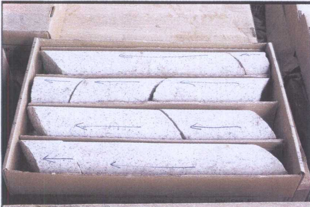
Caja 63 Sistema de fisuración subparalelo.
