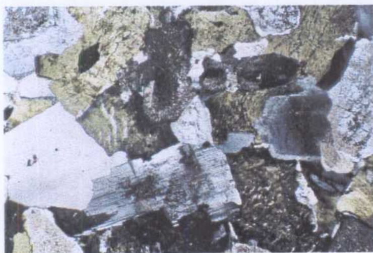
FOTO 6 Granito 'Blanco Cristal'; Facies común del sondeo. Relaciones texturales entre cuarzo, feldespato potásico y plagioclasa (NCx6.25)
