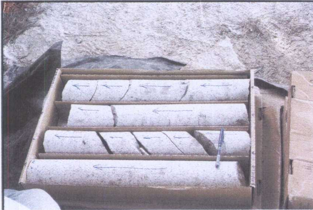
Caja 46 Sistema de fracturación paralelo a 50^\circ con el eje del sondeo.
