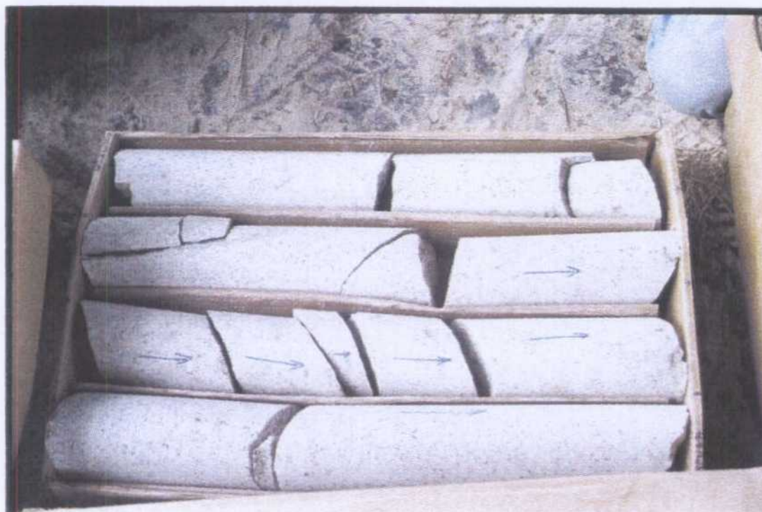
Caja 29c Aspecto general de sistema de fisuración subparalela.
