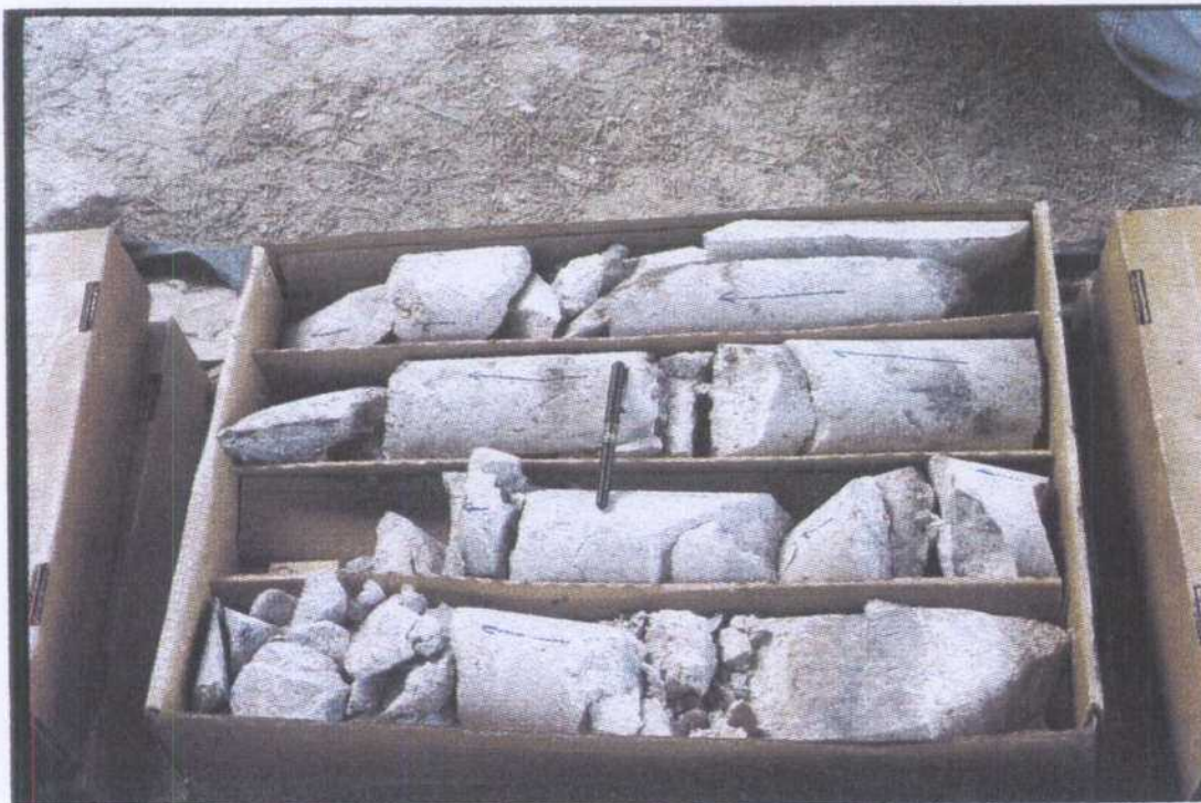
Caja 41 Zona de rotura; brecha de falla con epidotización y argilificación.
