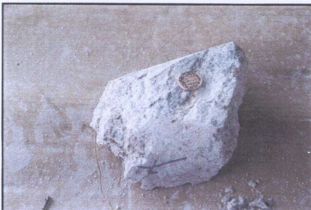
Caja 41e . Detalle de episienitización y fracturación frágil con brechificación.
