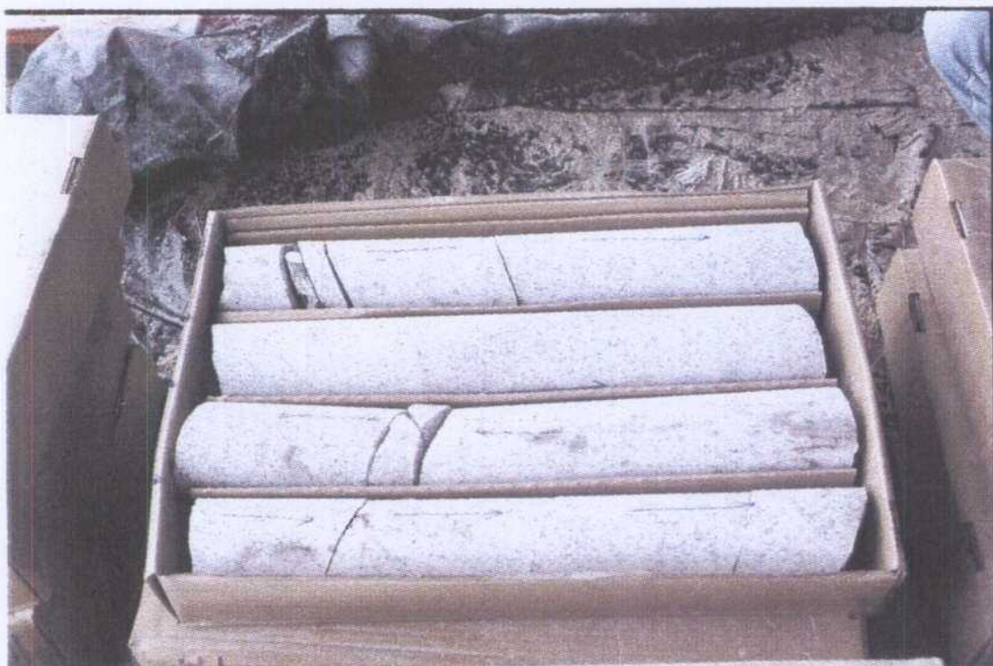
Caja 52 Sistema de partición paralela a 60°-65° con el eje del sondeo.
