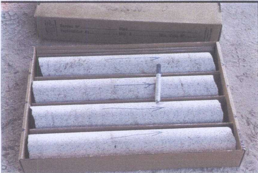
Caja 51 Sistema de partición paralela a 60^{\circ} - 65^{\circ} con el eje del sondeo.
