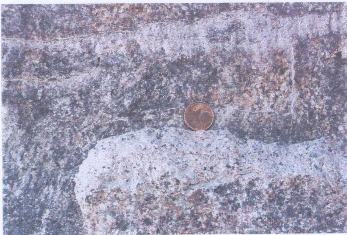
FOTO 1 Plano rugoso de fractura con estrías; detalle (Plano E-W, 85°-87°S).
