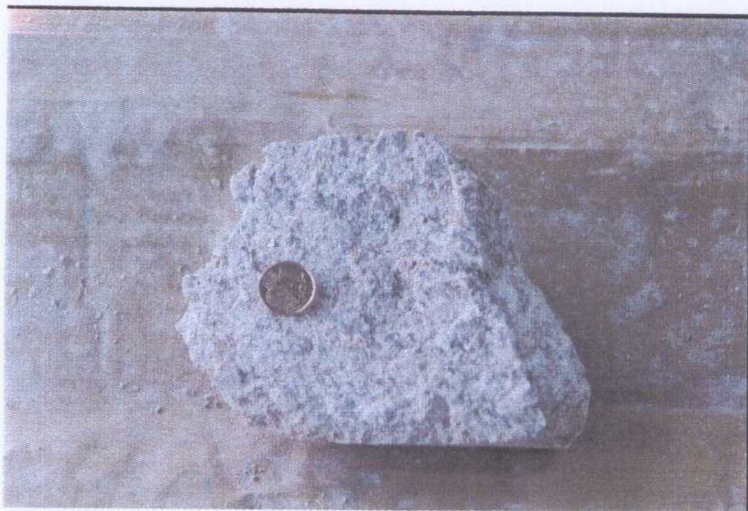
Caja 41e . Detalle de episienitización y fracturación frágil con brechificación.
