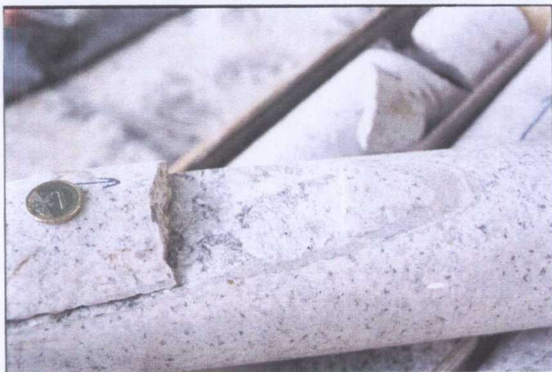
CAJA 29 . Aspecto general. Sistema de fisuras paralelas.
