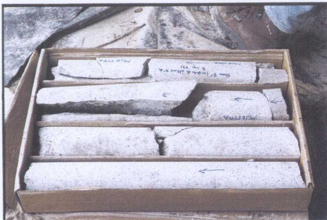
Caja 28c . Aspecto general. Fisuras subverticales.
